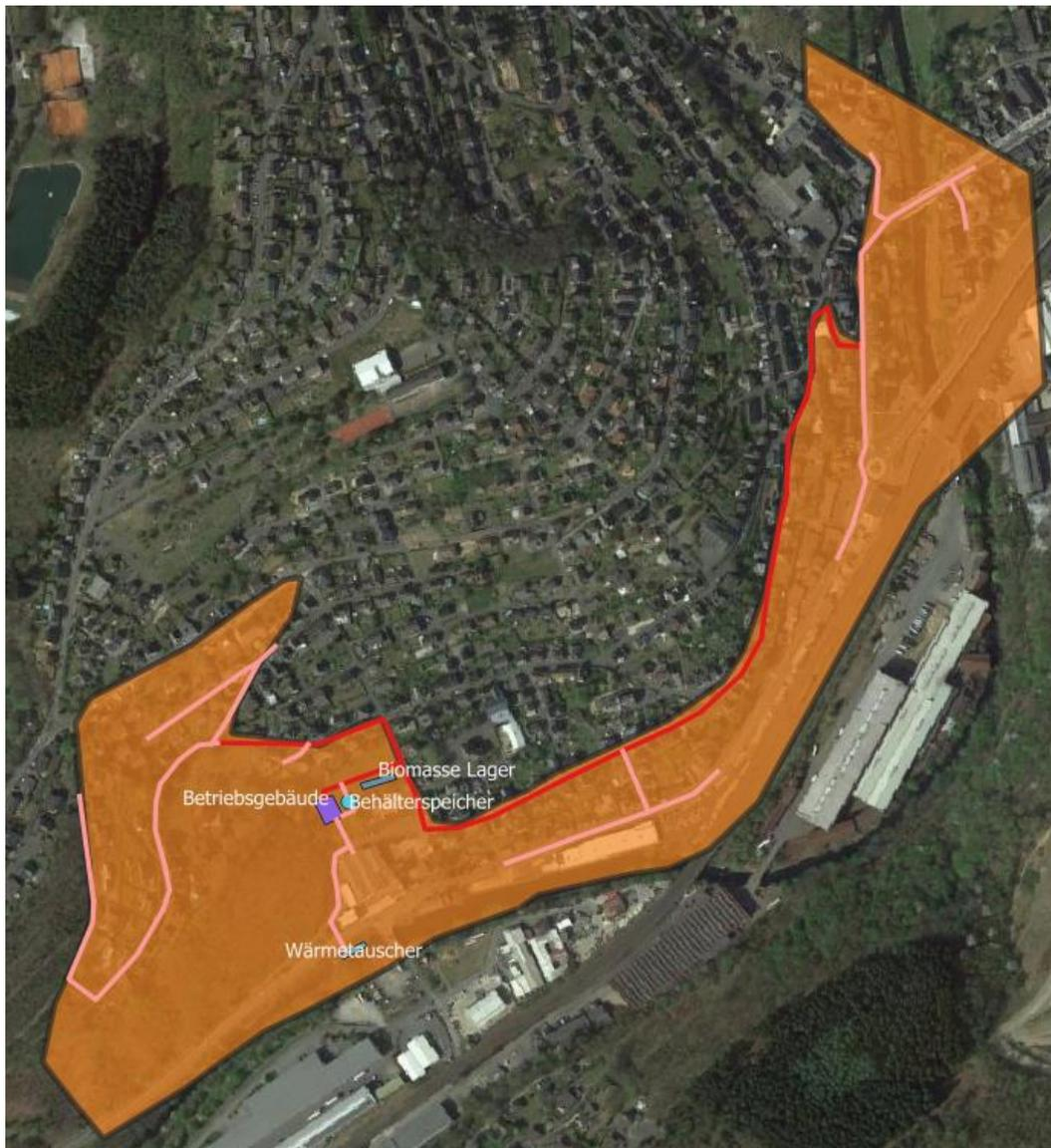
Abbildung 50: Trassenverlauf Wärmenetz und Standort Erzeugungs- und Speicheranlagen (Niederschelderhütte)
