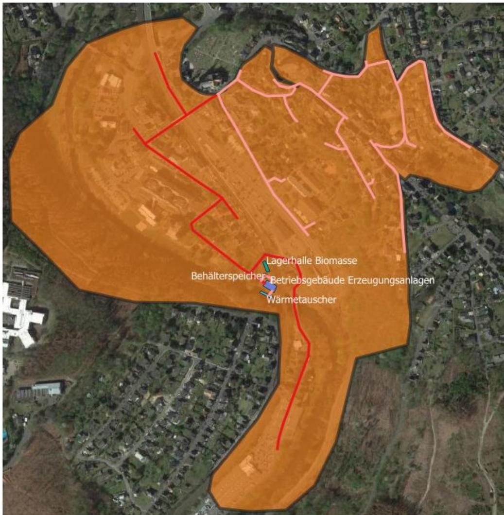
Abbildung 49: Trassenverlauf Wärmenetz und Standort Erzeugungs- und Speicheranlagen (Kirchen-Süd)
