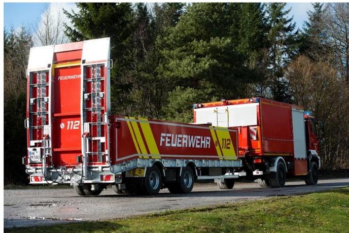
Dieser Anhänger verfügt über eine wasserdichte Ladefläche, in die mittels einer im Anhänger verbauten Seilwinde das Elektrofahrzeug gezogen werden kann. Anschließend wird der Trailer mit Wasser geflutet und kann dann 24 Stunden im Wasserbad abkühlen.
